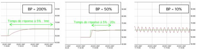
Dans le cas de figure où <u>la bande proportionnelle</u> est à <u>200%</u>, la stabilisation de l'ouverture de la vanne se fait très lentement. Par contre, il y a très peu de dépassement. Dans le cas de figure où <u>la bande proportionnelle</u> est à <u>10%</u>, la stabilisation ne s'effectue pas. La boucle de régulation devient instable. Le réglage de la bande proportionnelle est meilleur pour la valeur de 50%.
