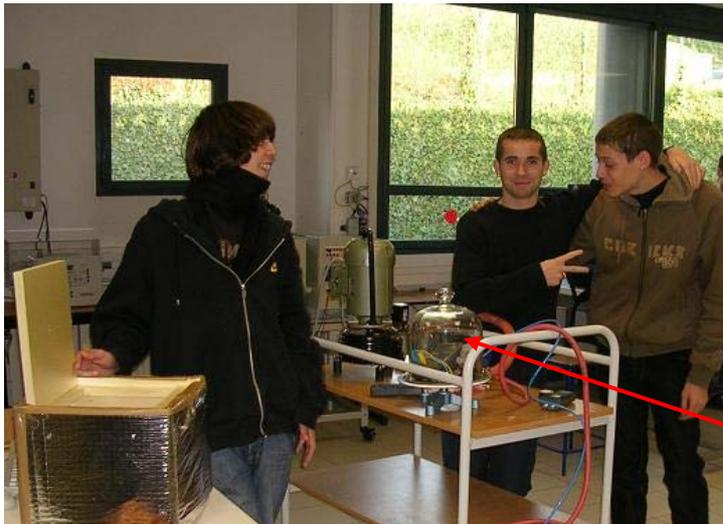
Nous avons placé notre capteur sous une cloche à vide et grâce aux différences de pression avons pu faire une courbe d'étalonnage. Nous avons relevé le voltage grâce à un voltmètre et la pression grâce à un manomètre *numérique* digitron.
