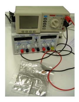
Nous pouvons vérifier expérimentalement que la capacité d'un condensateur peut varier de plusieurs façons :
