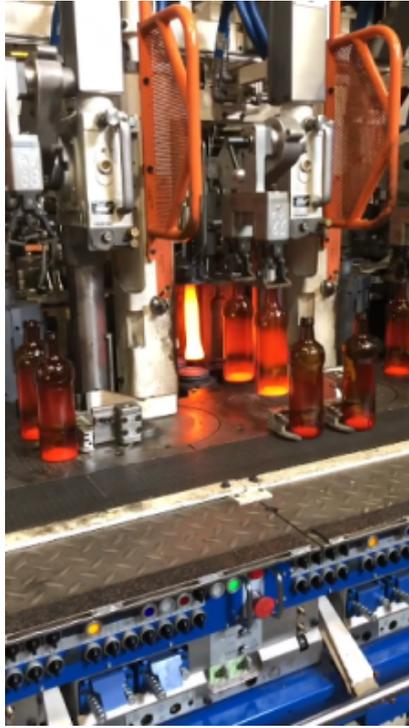
Il est indispensable de graisser régulièrement le moule, sinon le verre s'accroche au métal. On vient même graisser la paraison pour qu'elle tombe le plus vite possible dans le moule ébaucheur. La vitesse est essentielle pour que la paraison tombe bien au fond du moule ébaucheur où se forme le goulot.
